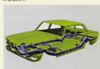
▲3代目から9代目までのクラウン（マジエスタを除く）に装着されていたペリメーター型フレーム。
